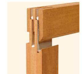
Le mode d'assemblage à double enfourchement collé
