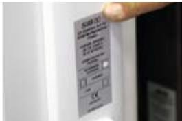
Etape de contrôle en fin de montage : chaque commande est validée avant emballage du produit. Le contrôleur va vérifier l'aspect dimensionnel, les coloris, options, fonctionnement des organes, apposer le marquage NF-CE attestant de la conformité du matériel livré. En cas d'anomalie, le matériel est réintégré dans le processus de fabrication pour modification.
