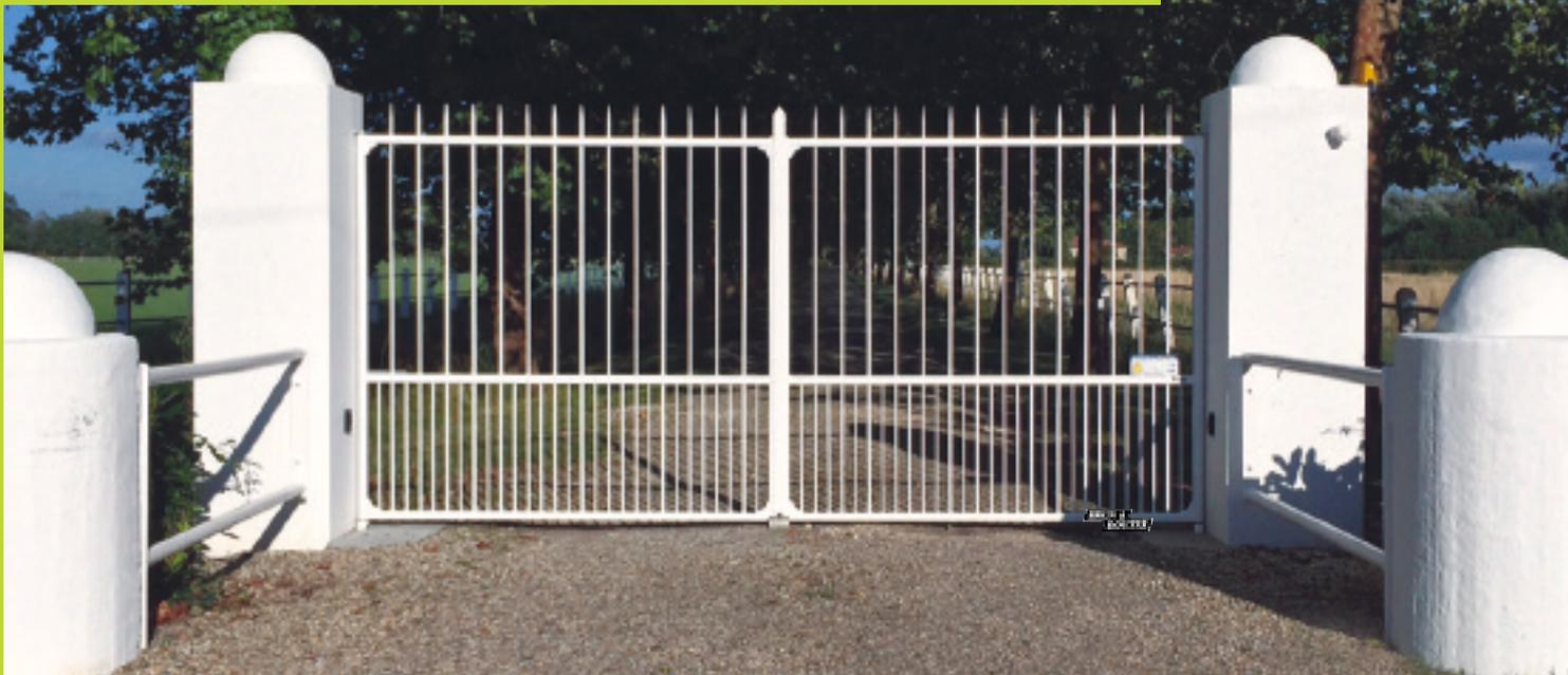
**PÉRIGORD** Portail battant et coulissant - Dimensions standard : hauteur 1,80 m, largeur entre piliers 3 m - 3,50 m - 4 m, ossature en tube carré de 40, barreaudage en rond plein de 16 appointé en partie haute, soubassement à double barreaudage en rond plein de 16 et rond plein de 12. **Portillon et clôture** assortis. Livré complet prêt à poser.
