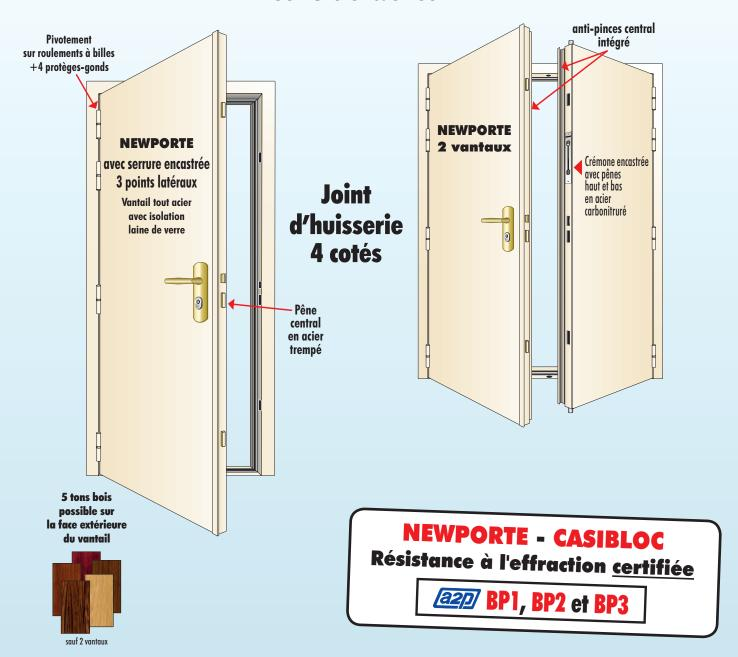
La porte d'entrée est totalement remplacée par notre bloc-porte qui comprend une porte et un bâti en acier entièrement sur mesure. Notre bâti recouvre ou remplace le bâti existant.
