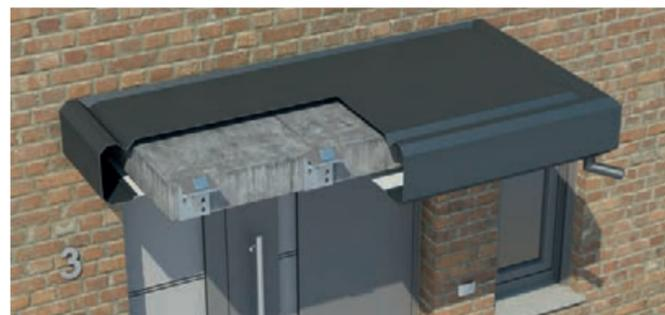
Au choix sous forme d'habillage (par exemple type KV 350). Dans ce cas de figure, la tôle murale est découpée à la dimension de la dalle en béton pour permettre l'enfilage de l'auvent sur cette dernière.
