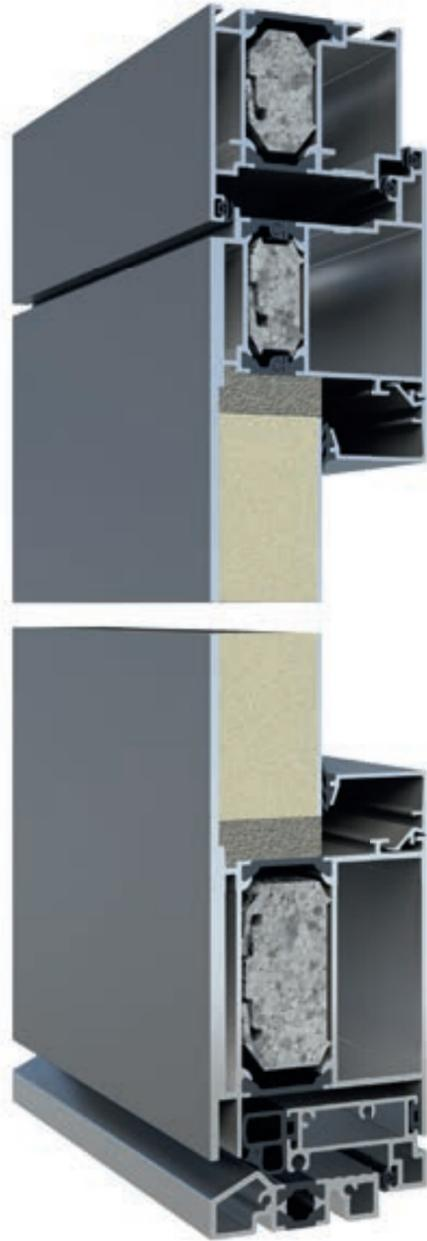
Le système KO 80 HD est notre profilé de base, disponible en ouverture intérieure et extérieure selon vos besoins. Le panneau peut être en feuillure, recouvrant l'ouvrant extérieur et recouvrant extérieur et intérieur. La mousse ISOPOR dans les profils et les 3 joints d'isolation garantissent une bonne isolation thermique. Ce profilé peut aussi être cintré (arc et plein cintre).
