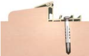
Fixation en rénovation
