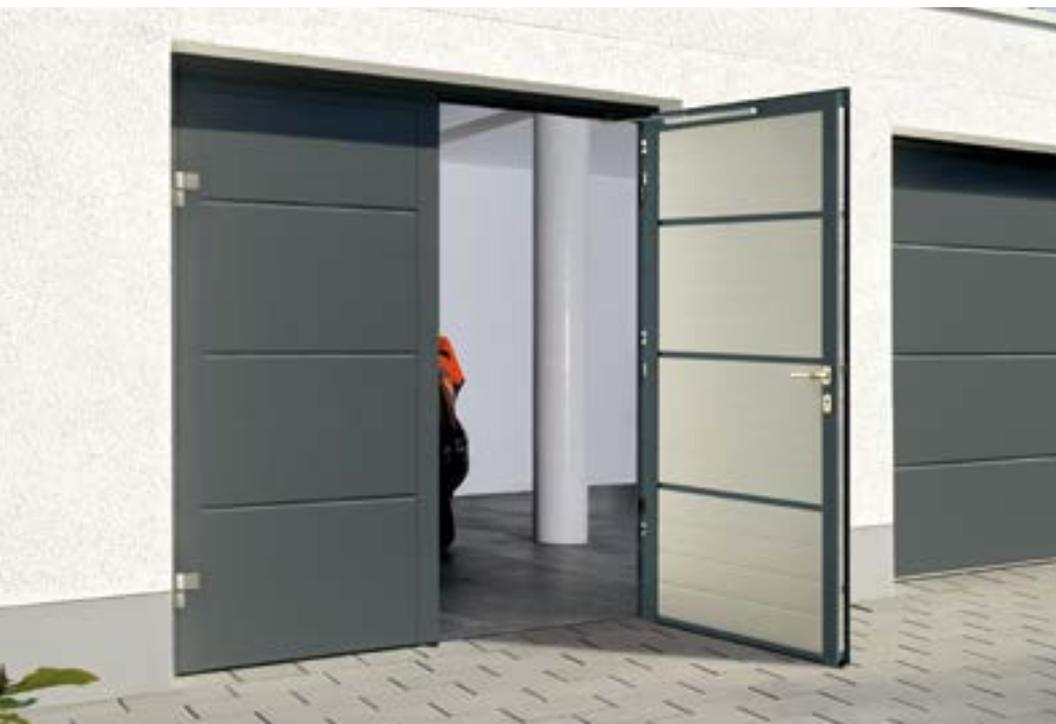
Bloc porte 2 vantaux ouverture vers l'extérieur, double paroi avec peinture d'apprêt extérieure blanche, équipé d'une serrure un point. Huisserie et cadre de vantail en aluminium. Panneau constitué de sections en acier galvanisé, d'épaisseur 42 mm, isolé de mousse polyuréthane sans CFC, finition stucco blanc-gris 9002 coté intérieur.
