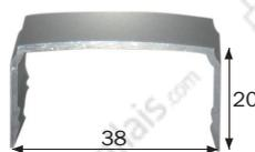
Gâche applique haute (porte feuillure) avec cales d'épaisseurs (3 de 2 mm, 1 de 1 mm)
